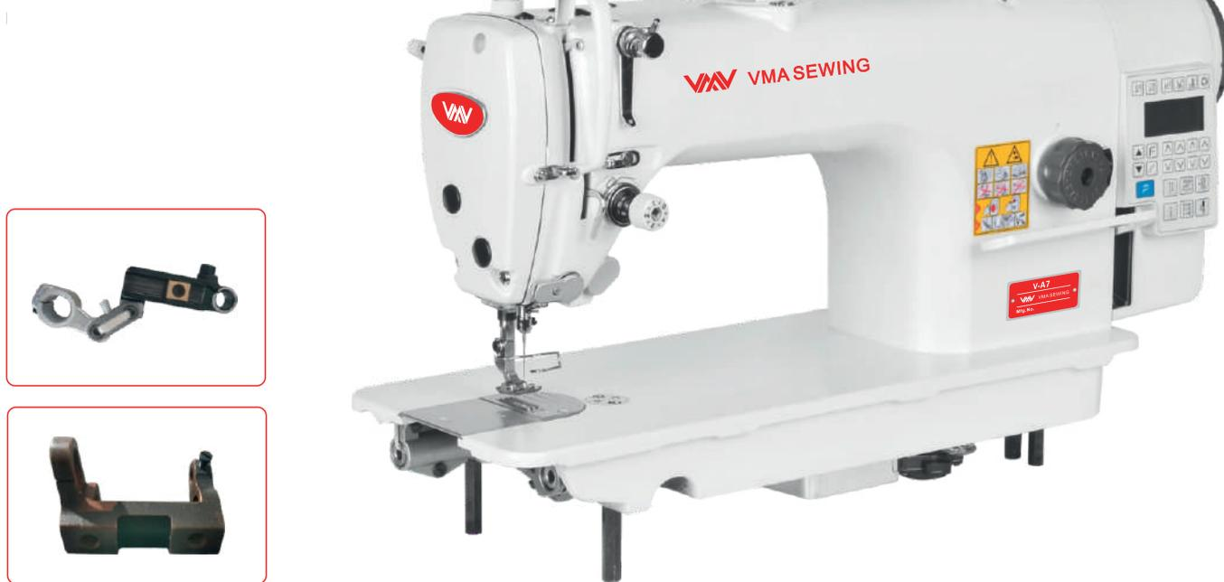
1. Игольводитель DLC, кронштейн игольвателя с высококачественными деталями, медный ползунок игольвателя, наиболее важные детали в этой машине.
