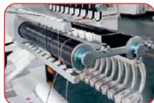
Оно может значительно сокращать сопротивление при движении пряжи. Оно особенно подходит для хрупких тканей и тканей с низкой эластичностью. Таким образом структура ткани сохраняется однородной и эффективность машины повышается.
