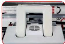
Рабочий ход автоматически регулируется в соответствии с шириной ткани; регулировка выполняется быстро, а позиционирование точно, что позволяет избежать бесполезных перемещений и значительно повысить эффективность производства машины.
