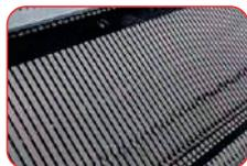
В разъемной конструкции используется импортная высококачественная стальная пластина; тонкое фрезерование снижает сопротивление движению игл и продлевает срок службы.
